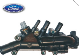
CÓD. INT. 8806 CÓD. PROD. 2015 150 VALVULA TERMOSTATICA COMPLETA FORD KA/COURIER ROCAM 1.0/1.6 FLEX
